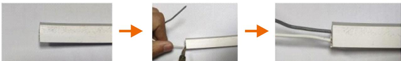
Для локального подключения рекомендуется использовать многожильный гибкий провод сечением от 0,14 до 0,5 кв.мм (AWG 26 – AWG 20) длиной до 15 см, до основной шины питания.
