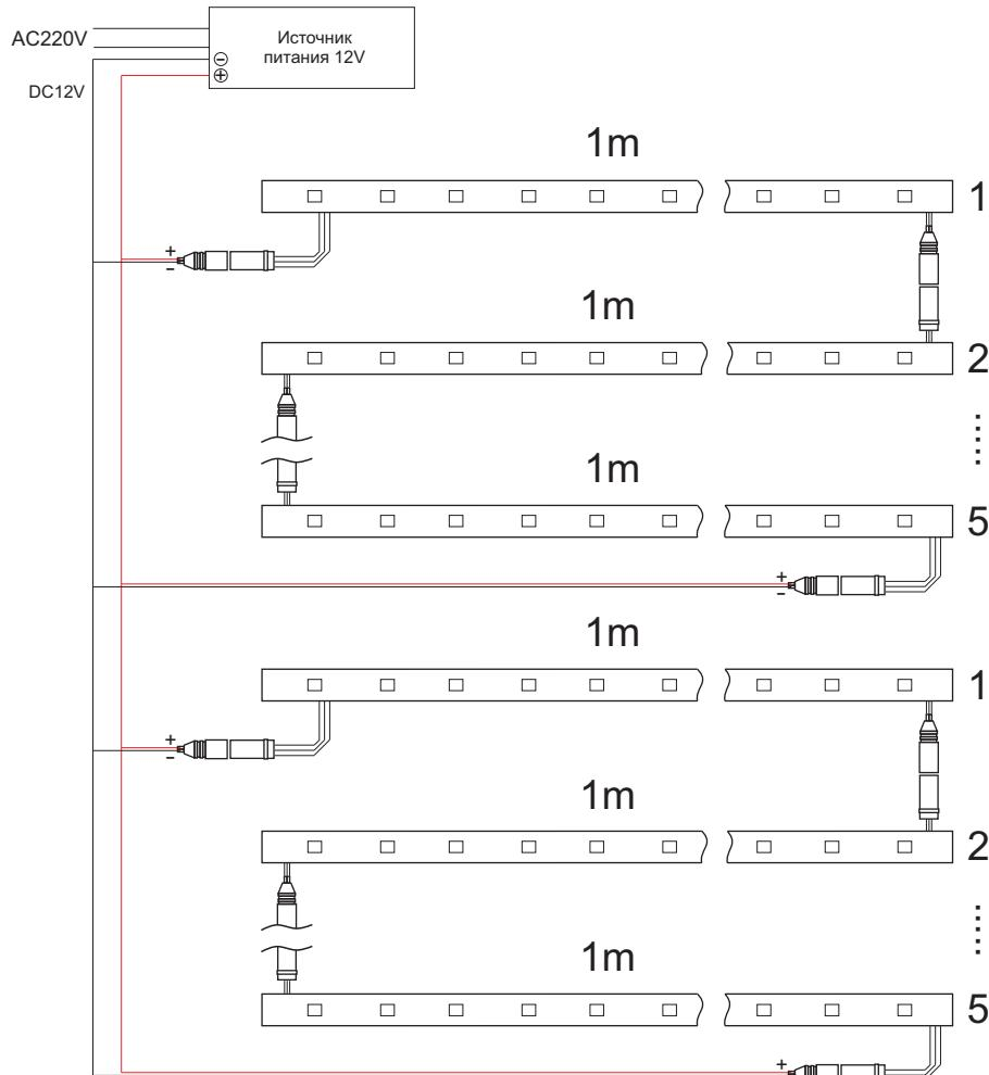
ПРИМЕЧАНИЕ: Обратитесь к схеме подключения для установки. Неправильное подключение может привести к короткому замыканию!
